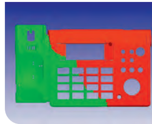
Die Anschnittverteilung zeigt, wie viel Schmelze über den jeweiligen Anschnitt, in diesem Fall zwei, in das Bauteil fließt. Ziel ist eine ausgewogene Verteilung im Bauteil.
