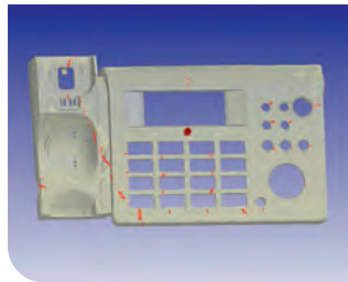
An den Stellen, an denen die Schmelzefronten aufeinandertreffen, entstehen Bindenähte – im Bild rot gekennzeichnet – das lässt Rückschlüsse auf die spätere Festigkeit des Bauteiles zu.
