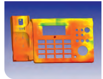
Eine ungleiche Temperaturverteilung lässt mögliche Problemstellen im Bauteil erkennen.
